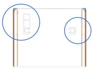
Das Einspritzen eines Acrylnitril-Butadien-Styrol-Copolymer (ABS) verträglichen Dicht und Klebstoffes kann eine zusätzlich ergänzende Maßnahme zum Abdichten des Formteiles an die Fensterbank darstellen.
