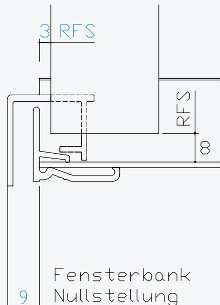
\*Abzugsmaß = Abschlusssaußenkante bis Nullstellung // Maßermittlung RFS = Abzugsmaß zzgl. waagerechter Abstand zur RFS
